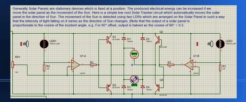
Un système d'éclairage solaire entièrement automatisé. La détection utilise des résistances dépendantes de la lumière, l'amplificateur opérationnel est un comparateur dans cette application. Copyright © David Norris, 2022
